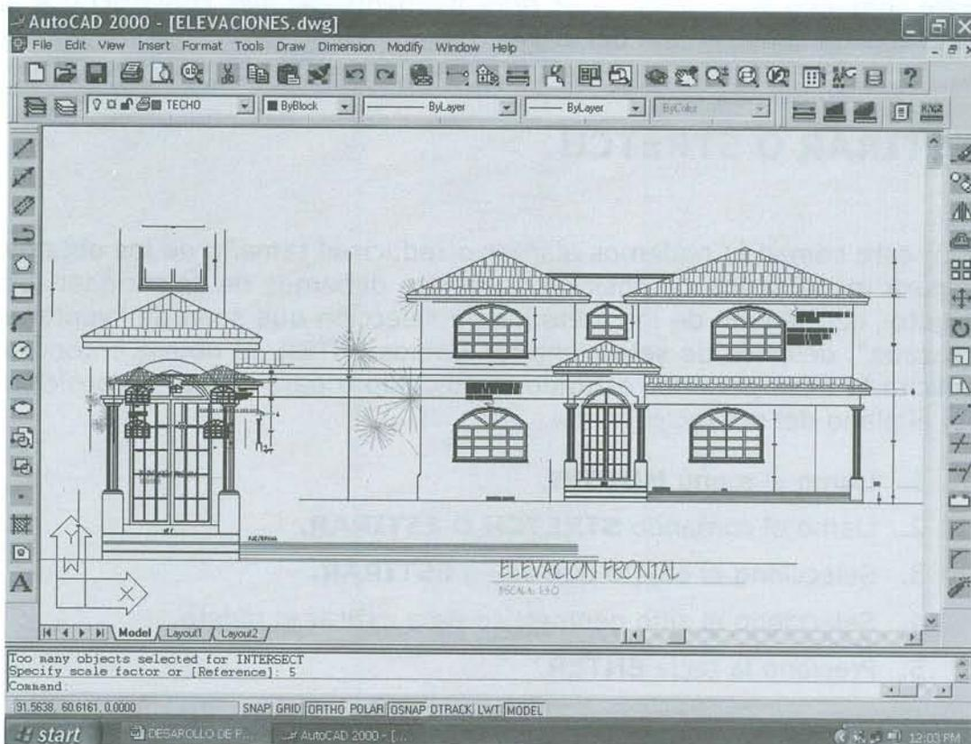
**FIGURA 168. USO DE SCALE O DE ESCALAR PARA AMPLIAR PARTES DESEADAS DEL PROYECTO Y HACER DETALLES CONSTRUCTIVOS**
